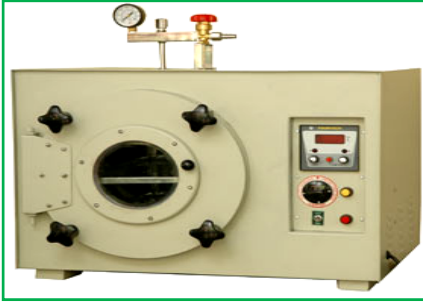
شكل ( 18 ) الفرن الحراري المفرغ
