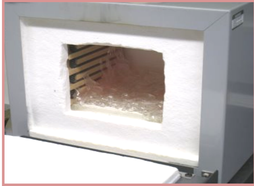
شكل ( 20 ) فرن حراري لتقدير الرماد في المواد الغذائية
