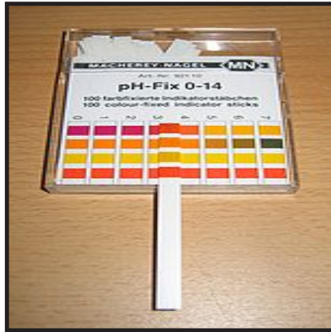
الشكل ( 52 ) اوراق البتموس التي تستعمل لقياس حموضة السوائل
